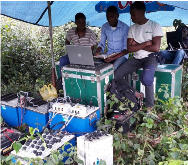
Mise en œuvre de la RMP sur le plateau d'Allada
