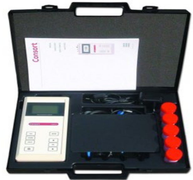
Conductimètre de marque consort C6030(analyseur électrochimique)
