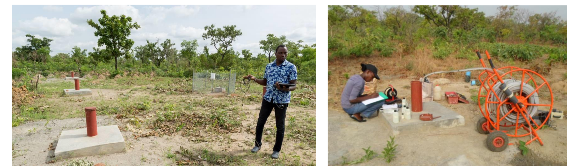
Figure 2 : forages et pluviomètre du site Ara Figure 3: Pompage pour prélèvements
