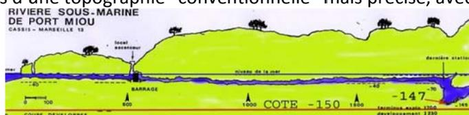
Figure 9 : plan coupe de la rivière souterraine de Port Miou.
