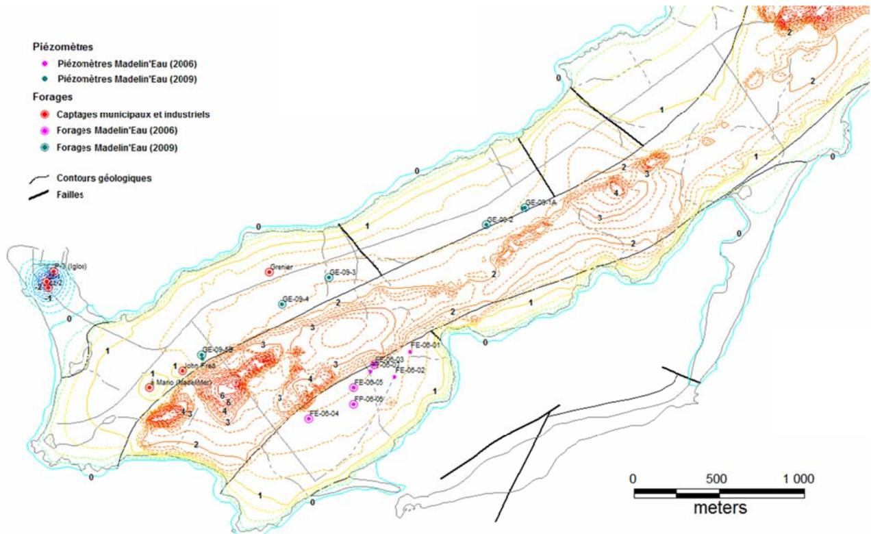
Figure 4 – Piézométrie simulée pour la situation hydrogéologique actuelle (avant exploitation)
