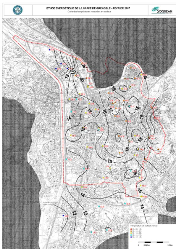
Figure 7 - Cartographie des températures mesurées en surface
