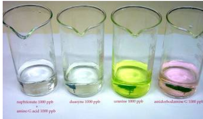
Figure 1 : Visibilité de traceurs usuels (concentration: 1000 ppb). L'impact est élevé pour l'uranine (vert) et l'amidorhodamine G (rouge), mais nul pour la duasyne, le naphthionate et l' amino G acide.
